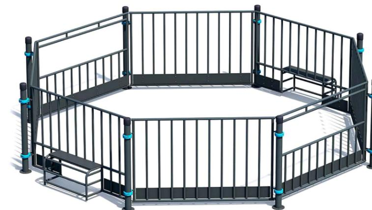
Комплекс состоит из восьми опорных столбов высотой 1600 мм, четырех секций стенка, двух секций с входом, двух секций с воротами. Ширина ворот 1030 мм, глубина - 420 мм, высота - 480 мм. Элементы крепятся к опорным столбам при помощи хомутов. Высота фиксации секций - 316 мм внизу и 1320 мм вверху от поверхности основания. Длина комплекса не более 6625 мм
